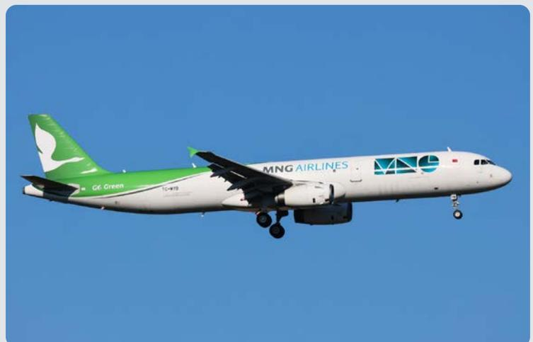
**✈ MNG Cargo A321:** Die türkische MNG Airlines betreibt diesen A321 in „Go Green“-Bemalung als Frachter. Die Bezeichnung des Typs, sichtbar unter der Registrierung, A321-200 P2F, lässt erkennen, dass diese Maschine früher Passagiere flog und jetzt Fracht befördert: „P2F“ steht für „Passenger to Freighter“. Foto: © Gerrit Griem
