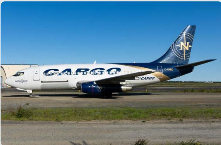
**✈ Nolinor Aviation B737-2:** Eine weitere Farbvariante der B737-200 Flotte von Nolinor Aviation trägt diese 47 Jahre alte Frachtversion. Gut zu erkennen am Bugrad ist das Gravel Kit für Starts und Landungen auf Schotterpisten, was verhindern soll, dass Steine und Schotter aufgewirbelt werden und in die Triebwerke gelangen. Foto: © Gerrit Griem
